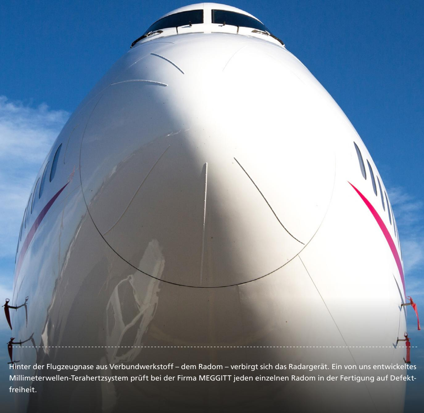
Hinter der Flugzeugnase aus Verbundwerkstoff – dem Radom – verbirgt sich das Radargerät. Ein von uns entwickeltes Millimeterwellen-Terahertzsystem prüft bei der Firma MEGGITT jeden einzelnen Radom in der Fertigung auf Defektfreiheit.
